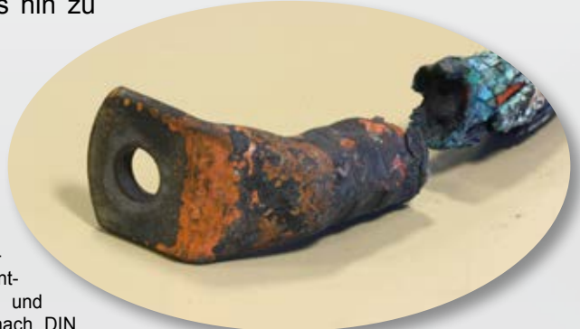
Bild 5: Kabelschuhe schlechter Qualität und/oder schlechte Verarbeitung können zu Bränden führen
