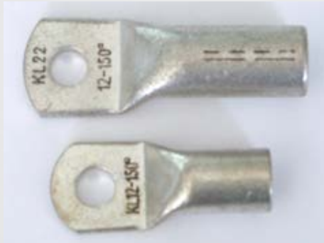
Bild 2: Nur der Presskabelschuh nach DIN 46235 (oben) weist die vom Hersteller vorgegebene Anzahl der Pressmarkierungen auf
